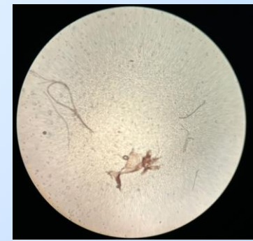
Vlakna iz obrabljene deski iz PP in AA pod mikroskopom
