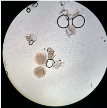
Peleti neobrabljene deske iz PP in PE pod mikroskopom
